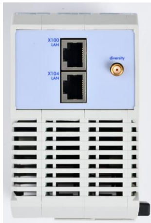
Aansluiting op RTU generatie 5X: onderzijde
